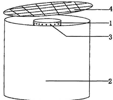
1、一种家用蚯蚓饲养器，其特征是：由下端封闭的外筒（2），设置于外筒（2）内、下端与外筒（2）内底部固定密封连接、上段分布有小孔（3）的内筒（1），以及有孔上盖（4）组成。
